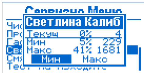
Фиг 16 Калибриране на светлинния сензор
